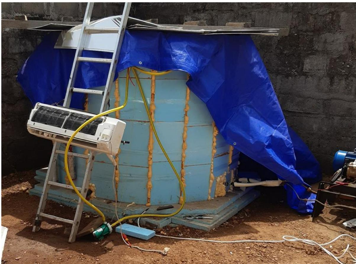
圖六：室內機正式運作前的前測：進水溫 1.5°C、入口空氣 35°C、出口空氣 24°C；室內機正式安裝在室內使用後，因為入口空氣比當初測試時的溫度還低，所以出風口的溫度實際上可降約 15°C
