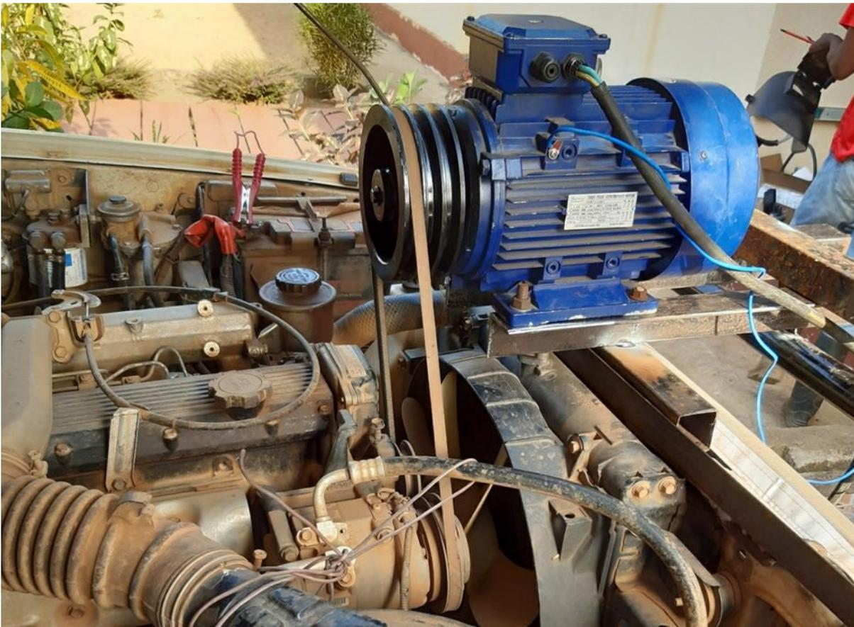
圖二：因為測試儀器有限，所以相關測試是在車用壓縮機被移除前利用馬達執行的。在此項測試中，馬達是用光電驅動的、而風扇則幫助空調系統（冷凝器）散熱。
