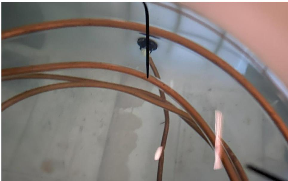
圖十: 使用半年後冷水槽內部狀況
