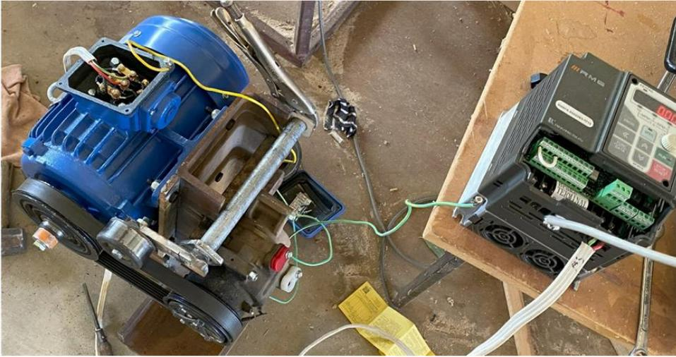
圖七: 馬達、壓縮機和皮帶張力器。以萬能鉗夾住的地方原本裝設一個彈簧，但之後因為機器運行中衍生的振動，我遂替換成液壓支撐桿以消弭震動力度。
