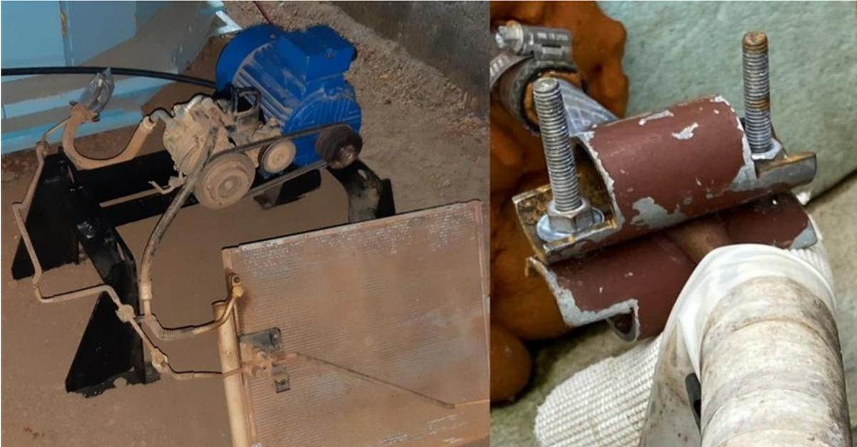
圖三：(左) - 焊接骨架, 3 相馬達, 壓縮機, 從報廢 Land Crusier 拔除的冷凝器。(右) - 自製電流勾表。
